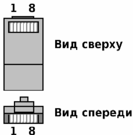
Рис. 5. Распиновка разъема RJ-45
