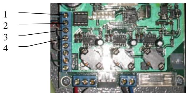
Рисунок 1.4 – Клеммы подключения кабеля связи
