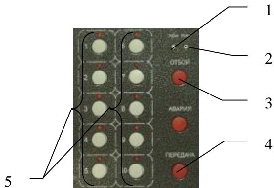
Рисунок 2.2 – Элементы управления и индикации сервисного меню
