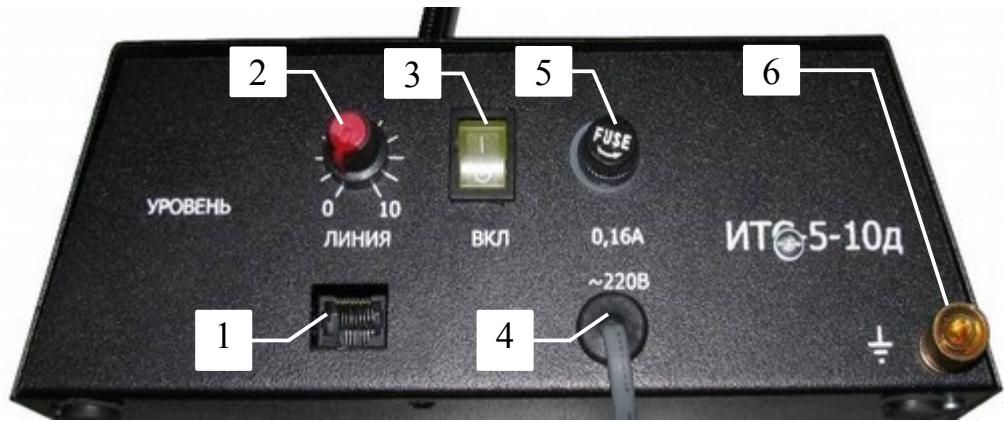
Рисунок 2.2 – Задняя панель ИТС-ЛС,
