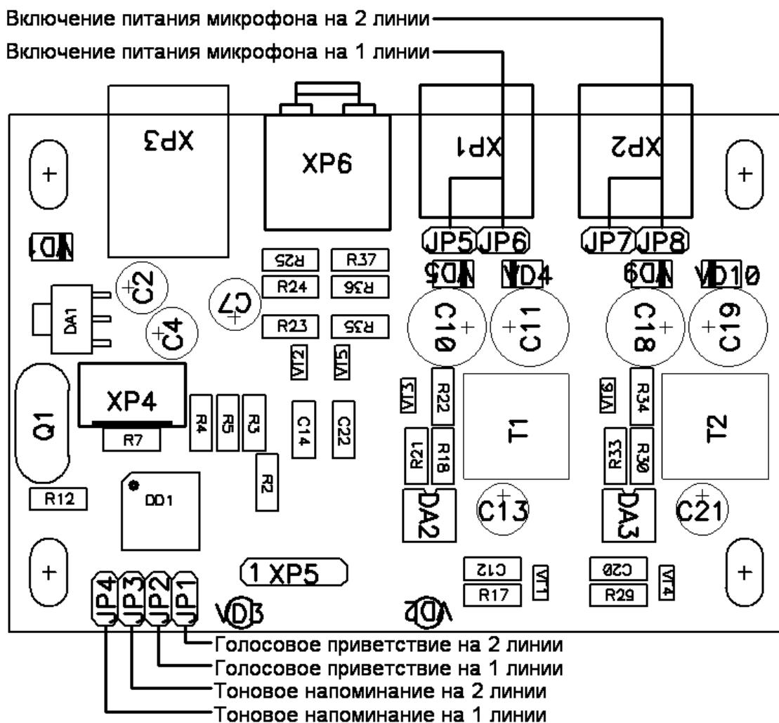
Вставленный (закороченный) джампер соответствует включенной функции.
